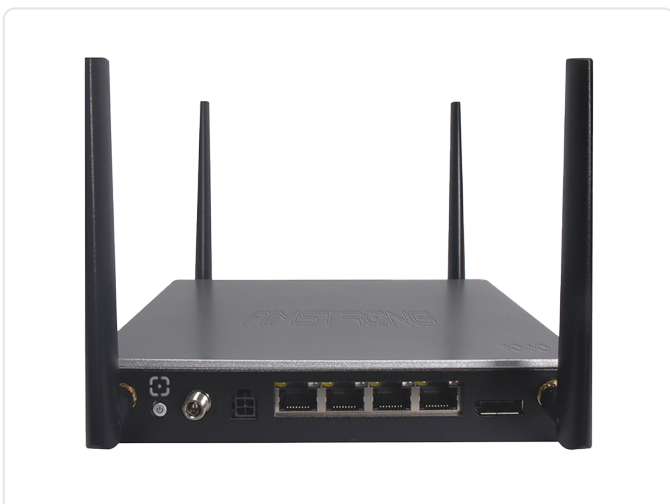
Frontseite: Power · SMA-Antenne · 4× 2.5GbE RJ45 · DisplayPort
