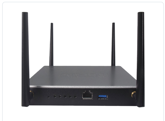
Rückseite: Console (RJ45) · USB 3.0 · SMA-Antennen (WiFi/LTE/5G)
